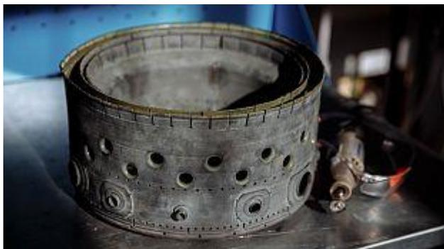
Ученые Самарского университета испытали одну из ключевых деталей авиационного газотурбинного двигателя - камеру сгорания, "выращенную" с помощью технологий 3D-печати. Она была установлена и испытана на серийном образце малого газотурбинного двигателя ТА-8 (МГТД), используемого в качестве вспомогательной энергетической установки самолета Ту-134.
